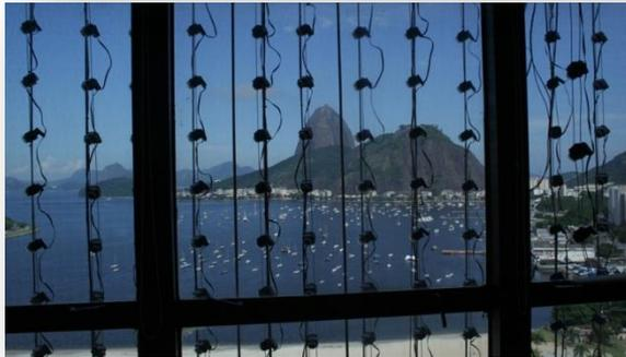
El clúster de led no funciona com una pantalla. El concepte del clúster és el píxel. Això permet crear pantalles gegants low-cost de qualsevol forma i mida.
