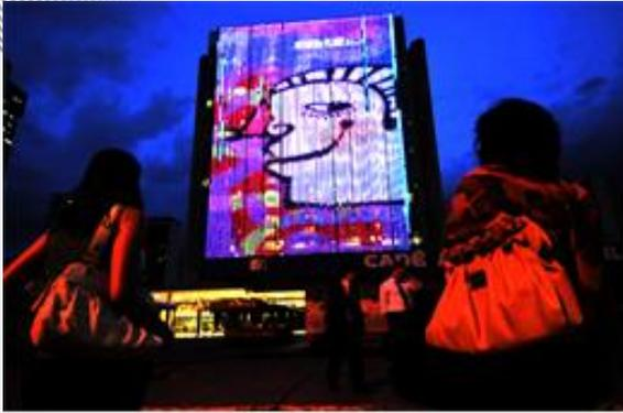
La tecnologia de clúster de led es desenvolupa per l'empresa *On Projeções* al Brasil per oferir una solució d'imatge digital i en moviment en formats gegants. Utilitzada en campanyes publicitària o qualsevol altre tipus de projecte on les dimensions o la forma impedeixen utilitzar mètodes tradicionals (Pantalles de LED o projecció) y on els costos serien prohibitius.
